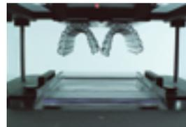
Abb. 4: Drucken von Schienen.
